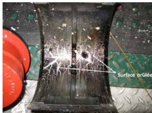
Photo 4. Coquille du coussinet de tête de bielle du bloc-cylindre 3
