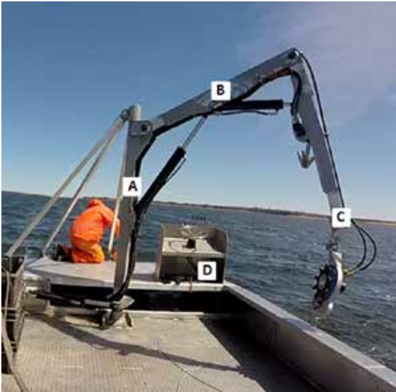
Figure 2. . Grue de pont du bateau d'aquaculture en cause (désignation des organes)
