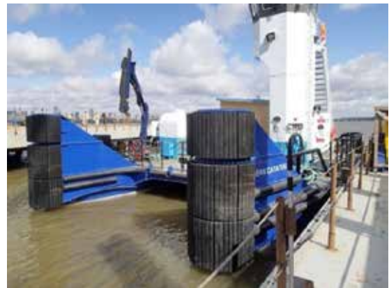
Figure 4. Twin hulls on Ocean Catatug 1 (Source: Groupe Océan)
