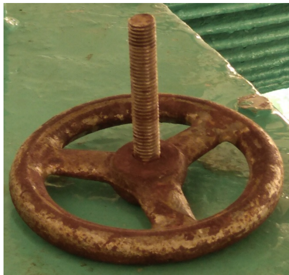
Figure 3. Outil de desserrage du frein pour le frein électromagnétique du moteur du treuil (Source : BST)
