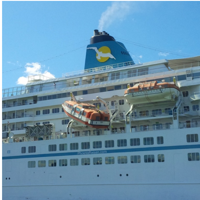
Figure 10. Embarcation de sauvetage n° 4 après l'abaissement non contrôlé de la potence arrière du bossoir (Source : BST)
