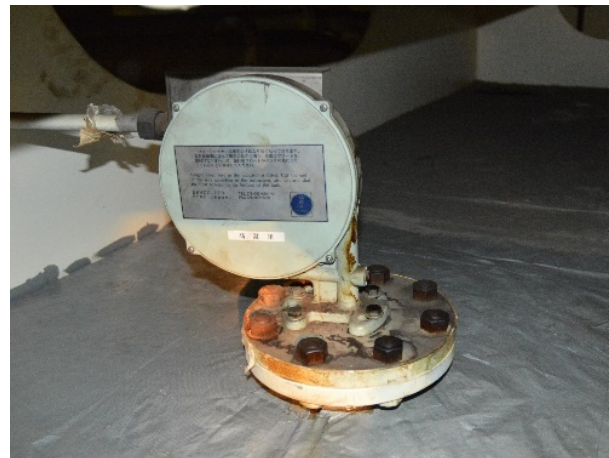
Figure 14. Type d'indicateur de niveau à flotteur initialement fixé par-dessus l'ouverture du tuyau de sonde du réservoir de décantation et la caisse journalière (Source : BST)
