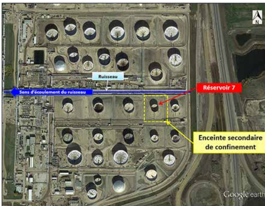
Figure 6. Le réservoir 7 et son enceinte secondaire de confinement (Source : Google Earth, avec annotations du BST)
