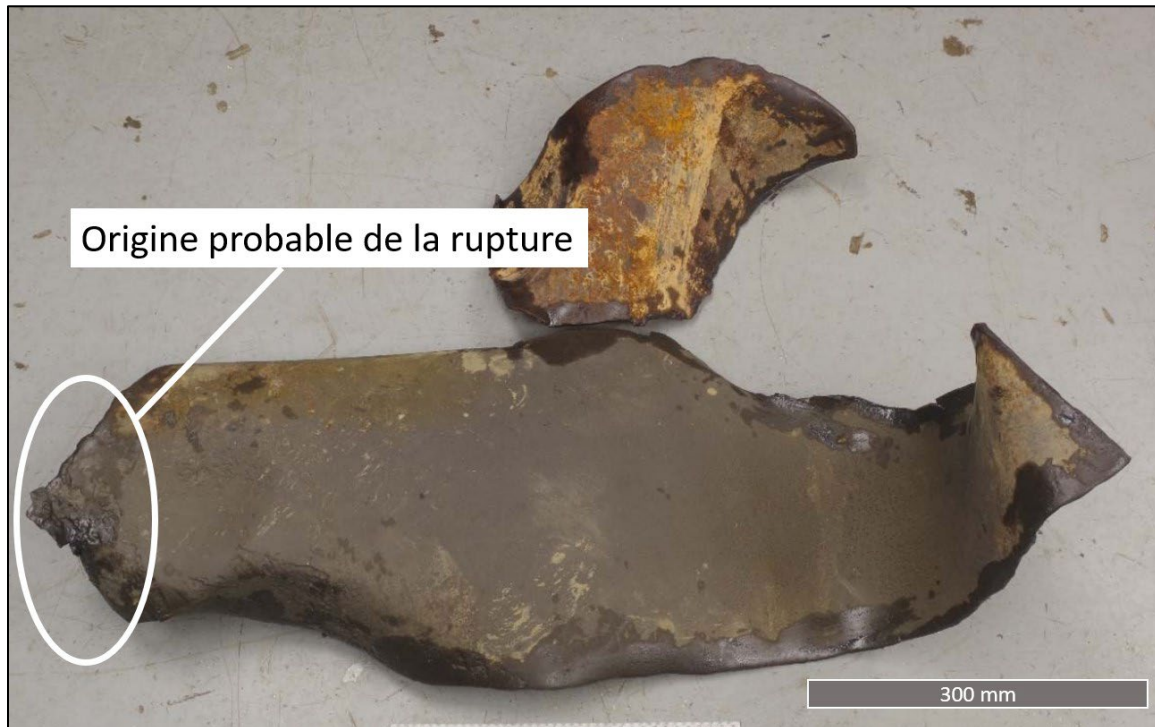
Figure 8. Segments de conduite éjectés (Source : Acuren Group Inc., avec annotations du BST)
