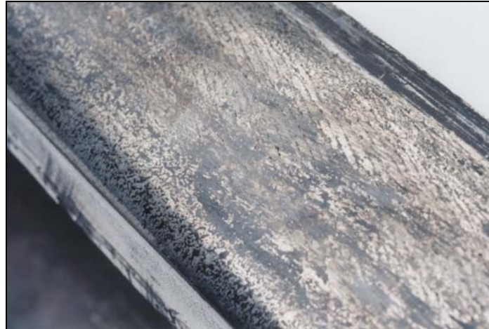
Photo 5. Fissures du champignon dans un bout de rail plus gros qu'on a récupéré
