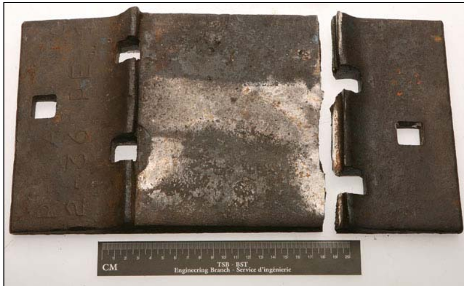
Photo 1. Selle de rail située sous le joint mixte
