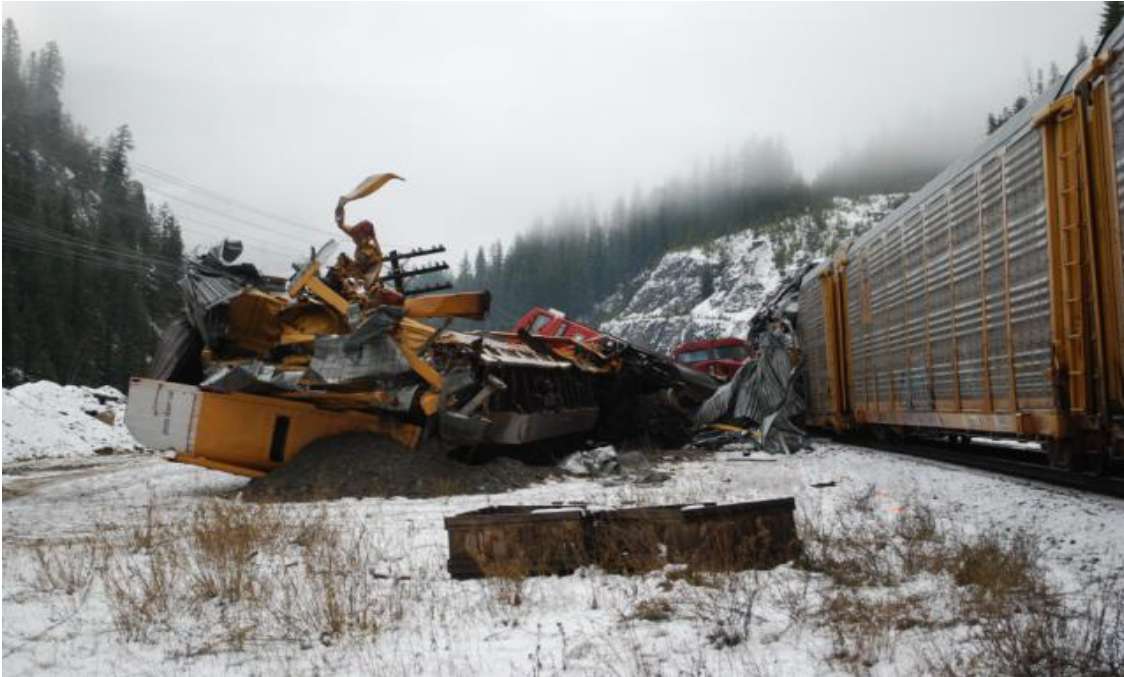
Photo 1. Dommages causés par le déraillement aux wagons porte-automobiles du train 110 et aux locomotives du Train 355
