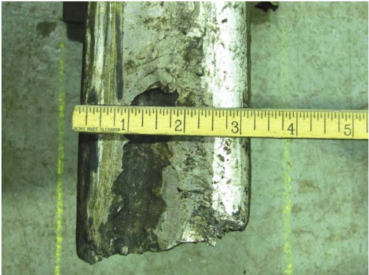
Photos 2 et 3. Rupture à l'extrémité sud des 3 morceaux appariés du rail ouest montrant un écoulement des matériaux et un craquelage prononcé sur le congé de roulement. Une section de 10 pouces de longueur du champignon a été écrasée, dont le point le plus profond mesure environ 7/16 de pouce. On a aussi relevé un shelling correspondant sur la surface de roulement à l'extrémité sud où s'est produite la rupture.
