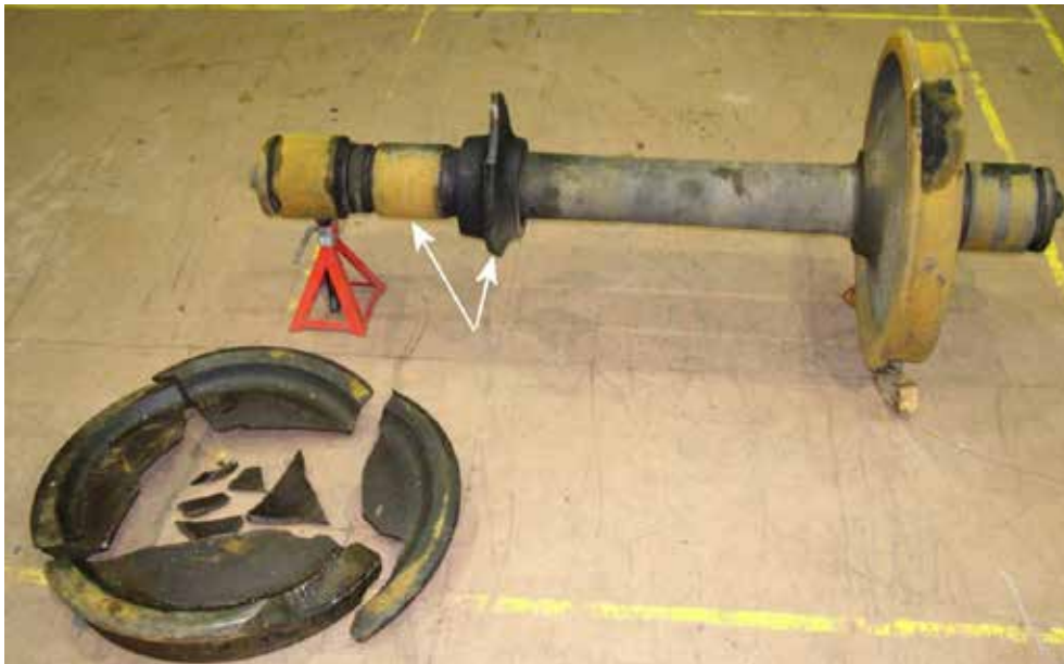
Photo 1. Roue L2 brisée et roue conjuguée
