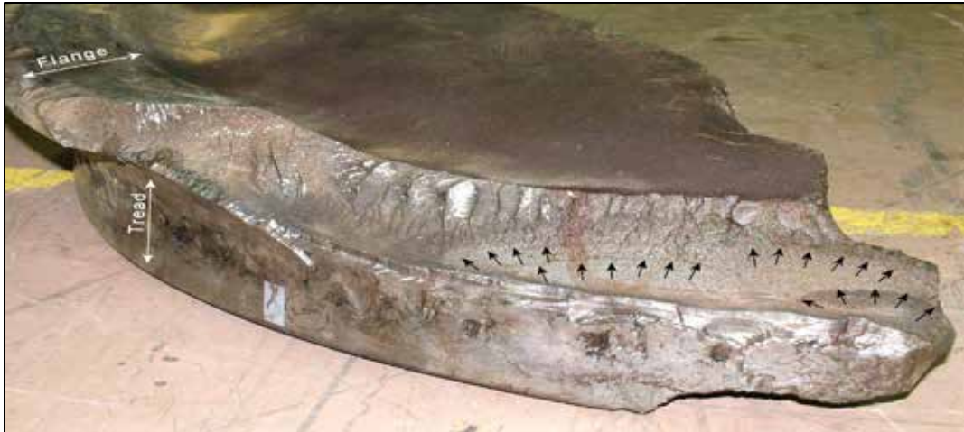
Photo 3. Les flèches indiquent des marques de référence qui permettent de conclure que la fissuration s'est faite progressivement.
