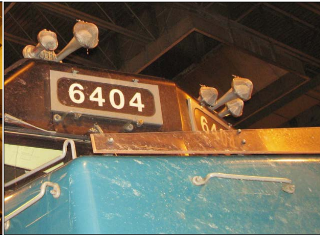
Photo 2. Klaxon d'urgence sur la locomotive VIA 6404
