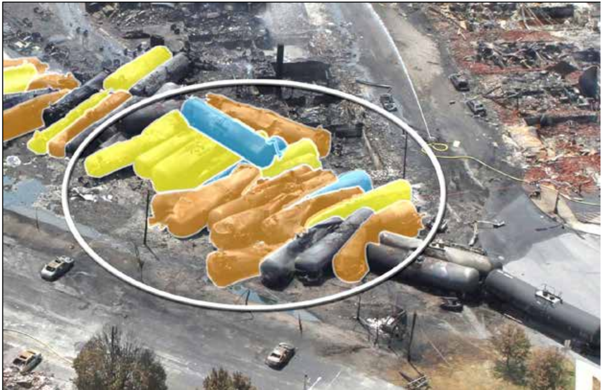
Photo 30. Concentration des perforations de grande dimension (orange) et de moyenne dimension (jaune) vers la queue du déraillement
