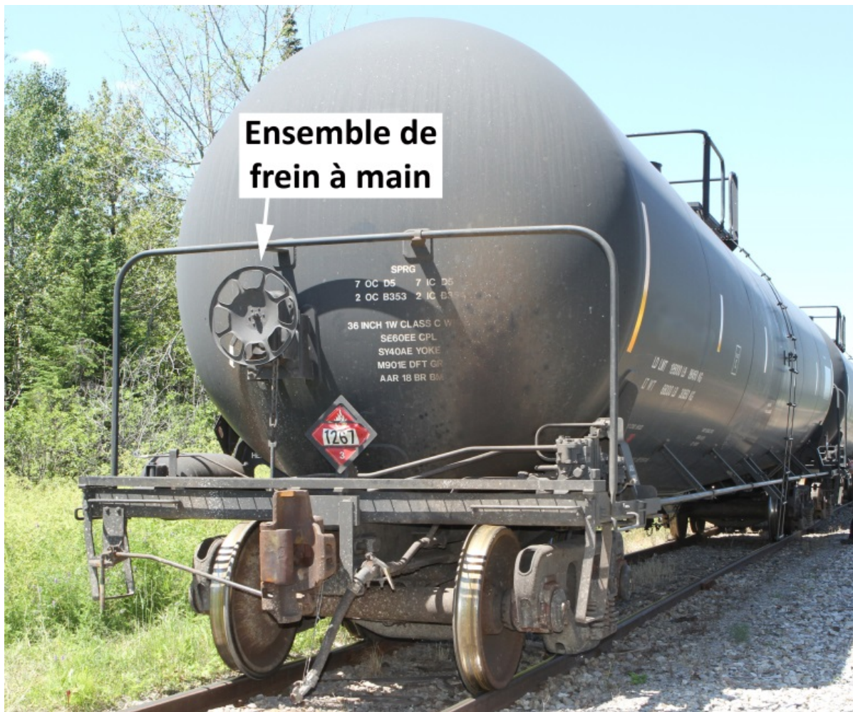
Photo 9. Timonerie et volant du frein à main à l'extrémité B d'un wagon-citerne
