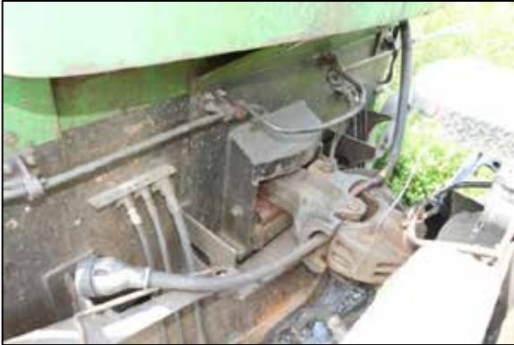
Photo 7. Conduite couplable coincée entre les mâchoires d'attelage de la deuxième et de la troisième locomotives (après l'accident)
