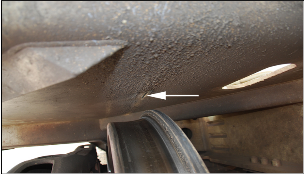
Photo 3. Marques d'impact à l'endroit où la roue a heurté la tôle de plancher en bout
