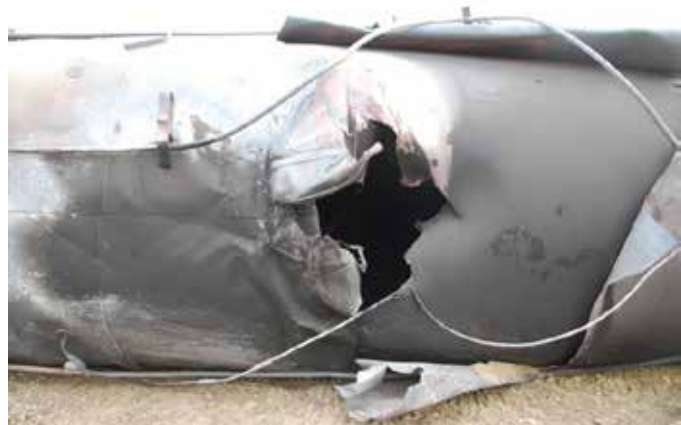
Photo 1. Perforation dans le dessous de UTLX 955375
