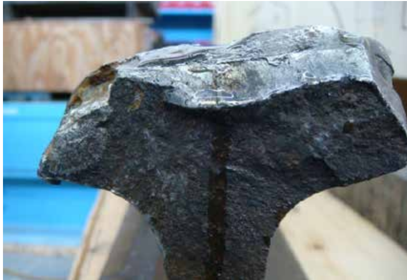
Photo 9. Dommages par impact de roue sur l'échantillon de rail TSB-3 (Source : Exova)
