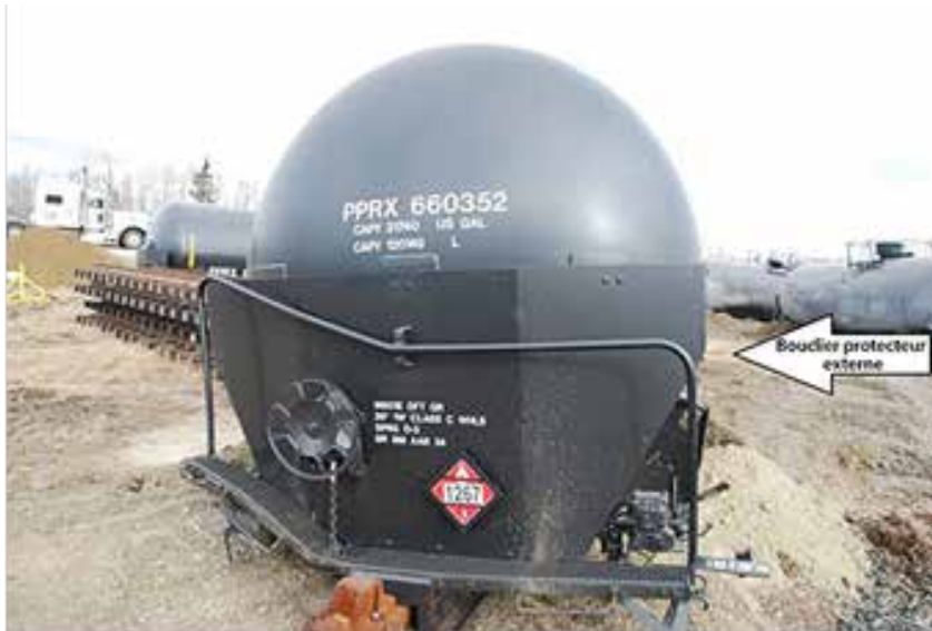
Photo 2. Protection extérieure par demi-boucliers protecteurs
