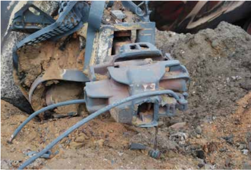
Photo 4. Rupture d'un bras d'attelage, avec attelages à double plateau encore accrochés
