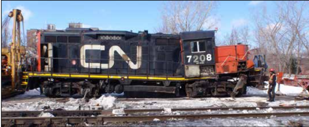
Photo 2. Locomotive CN 7208 après que son châssis s'est plié
