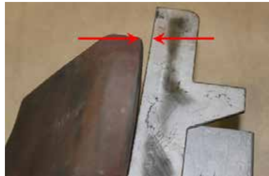
Photo 3. Patin stabilisateur représentatif montrant l'étendue de l'usure (les flèches pointent vers l'intervalle entre la surface de contact et une règle droite)
