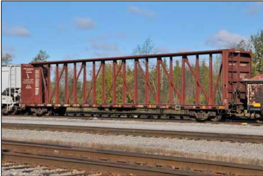
Photo 2. Wagon plat à poutre centrale similaire au wagon GTW 623373 (source : Ian A. McCord)
