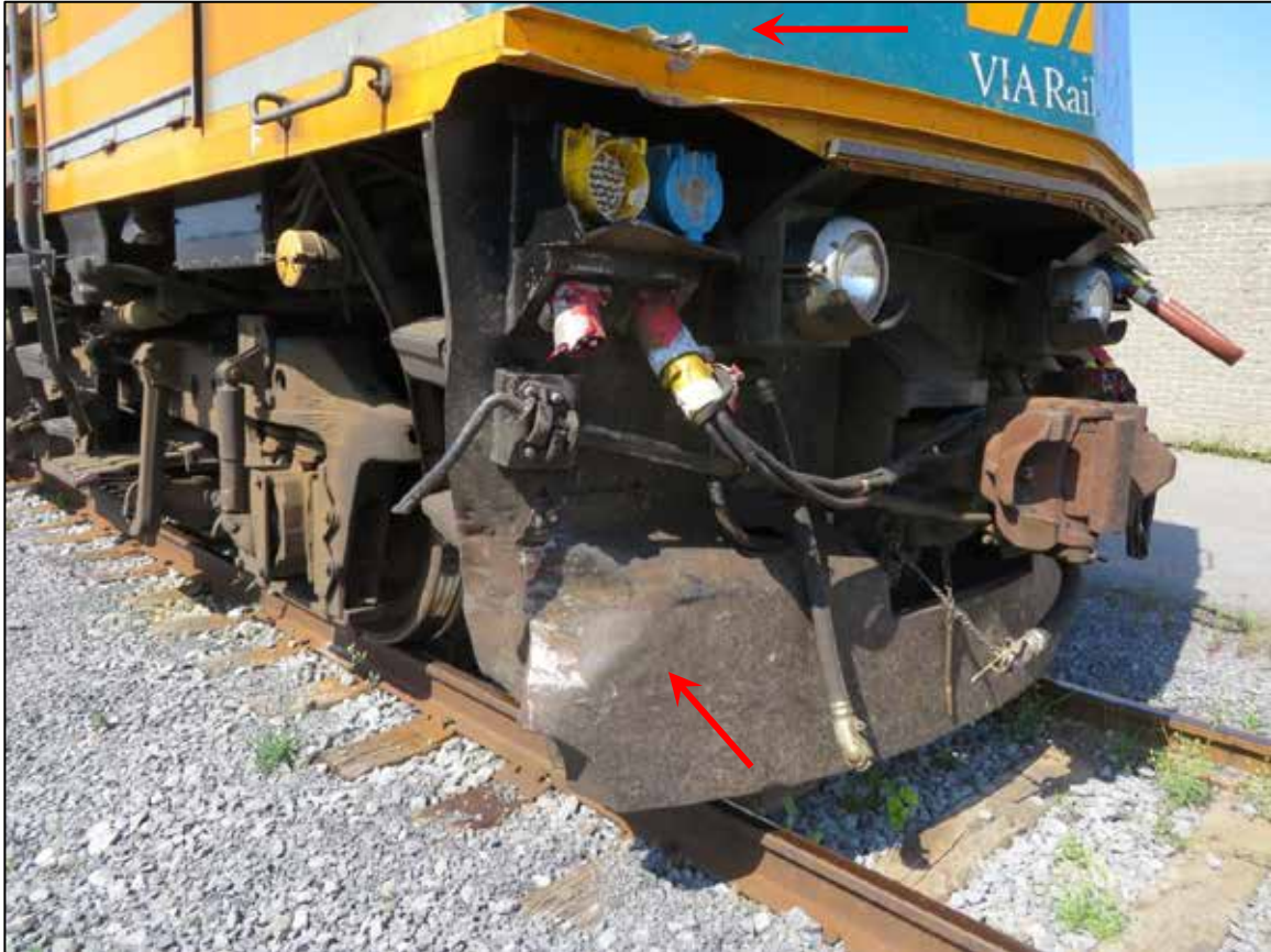
Photo 1. Locomotive VIA 6424 montrant des dommages d'impact (flèches rouges)
