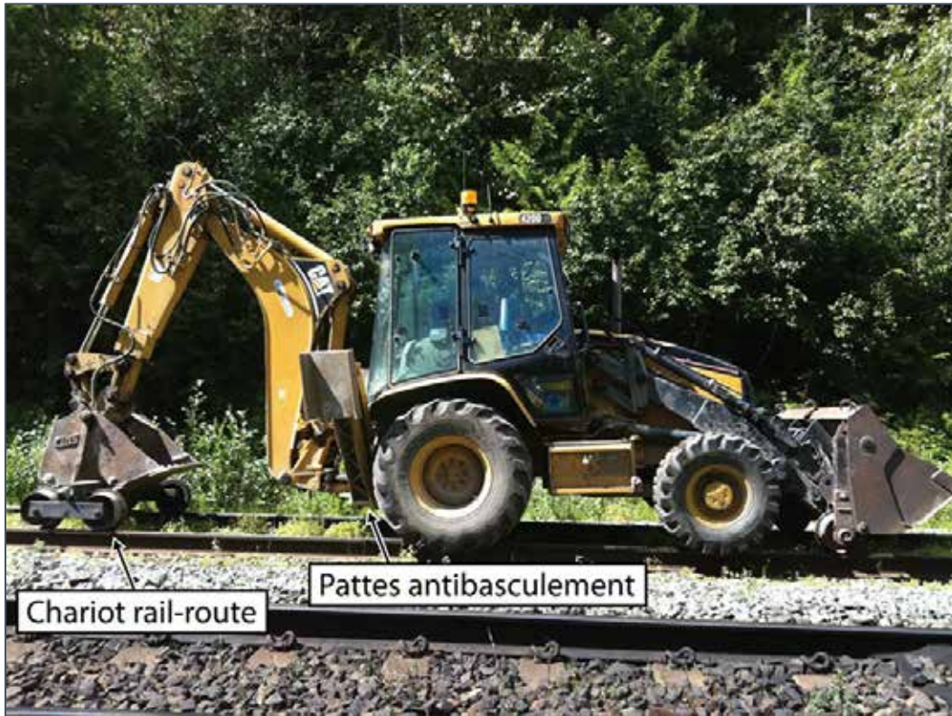
Figure 4. Rétrocaveuse avec chariot rail-route semblable à celle à l'étude
