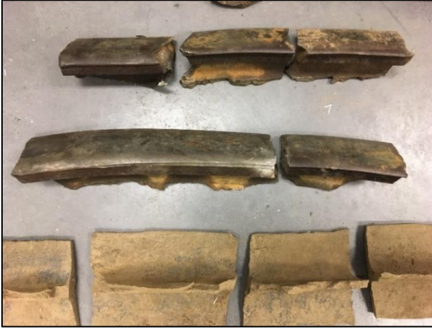
Figure 13. Fragments de rail récupérés (Source : BST)
