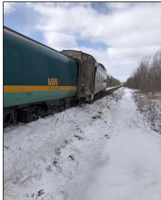
Figure 3. Les 2 dernières voitures VIA déraillées, en position verticale (Source : CN)
