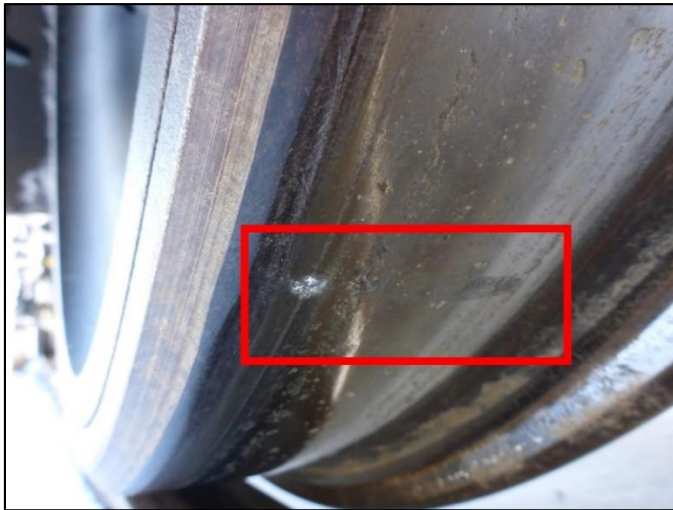
Figure 6. Marque d'impact sur la roue de la 10 e voiture (Source : BST)
