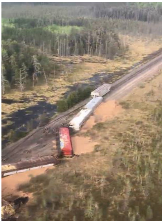
Figure 4. Accumulation d'eau à côté de la voie nord (Source : Canadien Pacifique)
